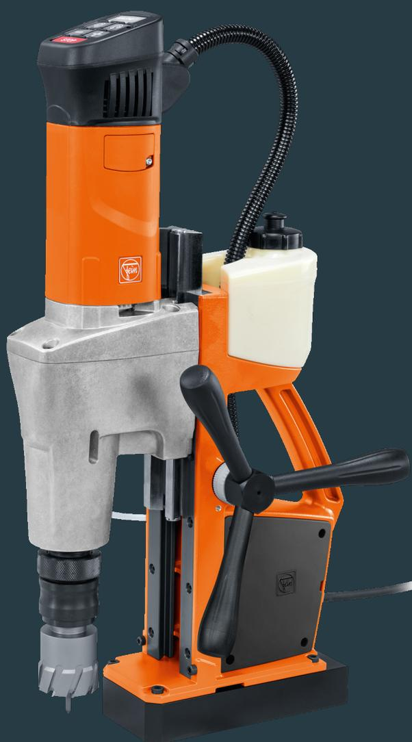
Trapano universale con punta a corona a base magnetica a 2 velocità, leggero e con una corsa estremamente ampia, rotazione a sinistra/destra, attacco portautensile CM3 e la massima funzionalità per lavorare in modo flessibile in officina e in cantiere.
