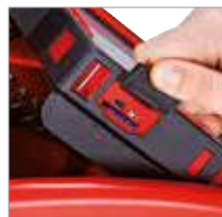
Protezione per le connessioni SD-Card, Micro-Hdmi, Mini-USB
