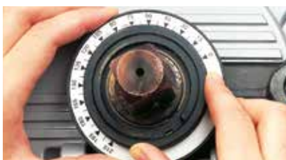
Regolazione dell'angolo di curvatura senza utensili
